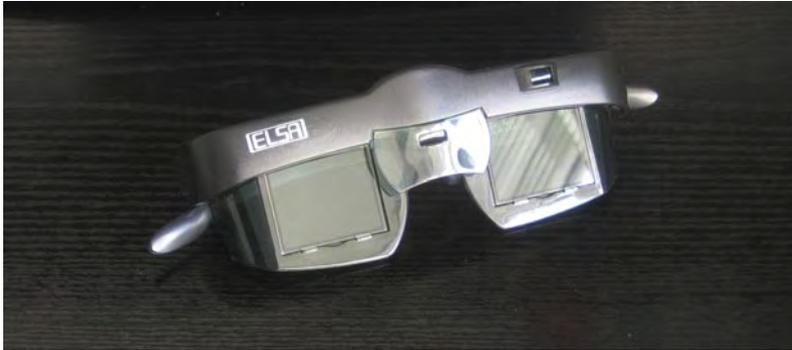
In der Shutterbrille befinden sich vor jedem Auge 1-Bit LCDs. Diese können jeweils ein Auge synchron zu einem Bildschirm zu- bzw. abdecken. Wenn der Bildschirm das Bild für das rechte Auge zeigt, wird das linke Auge in diesem Moment abgedeckt. Die Wiederholungsrate dieses Vorgangs wird durch die Hertzzahl des Monitors beschränkt. Anwendung fand diese Technik bei PC-Spielen und in IMAX-Dome-Kinos.
